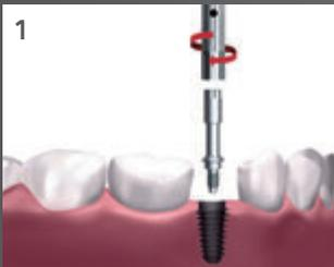
1. Der MultiPeg<sup>™</sup> wird mit dem Implantat verbunden. Es lässt sich mühelos in das Innengewinde des Implantats einschrauben (Drehmoment ca. 6–8Ncm).
