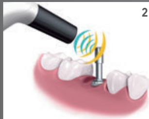
2. Richten Sie Osseo 100 einfach auf den Magnet an der Oberseite des MultiPeg<sup>™</sup>. Nichtinvasiv, objektiv, genau und wiederholbar. Der Peg wird durch Magnetimpulse aktiviert und vibriert aufgrund der Steifigkeit im Kontaktbereich zwischen Knochen und der Oberfläche des Implantats.
