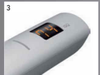
3. Es wird ein ISQ-Wert erzeugt und auf dem Display angezeigt. Dieser steht für den Grad der Stabilität auf der universellen ISQ-Skala – zwischen 1 und 99. Je höher der ISQ-Wert, desto stabiler das Implantat.
