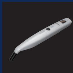
**7** Wann kann ein Implantat belastet werden? Das Osseointegrations-Messgerät Osseo 100+ gibt mehr Sicherheit in dieser Frage und lässt sich an Surgic Pro2 anbinden.
