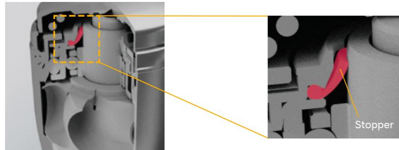
Bei Luftzufuhr gerät der Stopper in einen Schwebezustand. Wird die Luftzufuhr unterbrochen, berührt der Stopper den rotierenden Schaft und bremst diesen ab.
