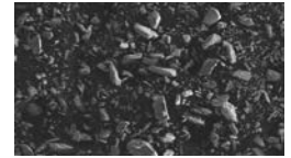
Perio Mate Powder (Glycin) durchschnittliche Partikelgröße etwa 25µm, SEM-Aufnahme (x150)
