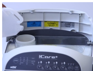
Abb.12 – Füllen des Öltanks
