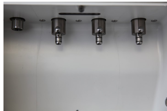
Abb.18 – iCare+ C3 mit Adaptern für 3 Winkelstücke
