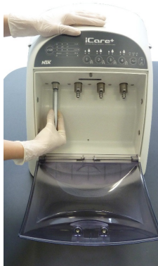
Abb.14 – Verbinden einer Turbine mit Midwest 4-Loch Anschluss
