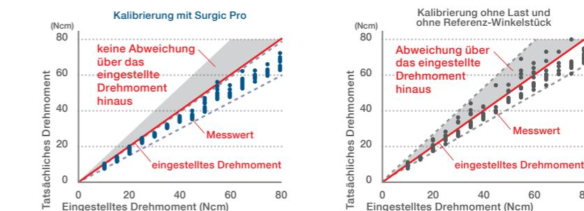
Beim Kalibrieren mit Surgic Pro kommt es kaum zu Abweichungen, d.h. der eingestellte Drehmomentwert wird nicht überschritten. Dies bietet eine überragende Sicherheit. Die Abbildung zeigt, dass ein exaktes Kalibrieren nur möglich ist, wenn dabei das tatsächlich zum Einsatz kommende Winkelstück berücksichtigt wird.
